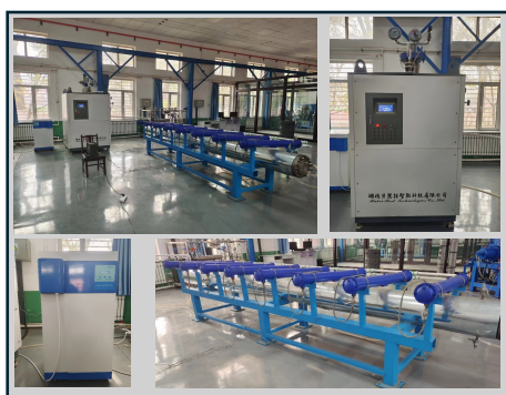
图 3 高温高压蒸汽对流加热系统
